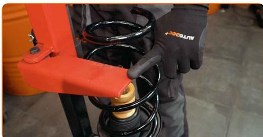
**40** Instale el soporte de montaje superior del puntal y el cojinete del soporte de montaje del puntal.
