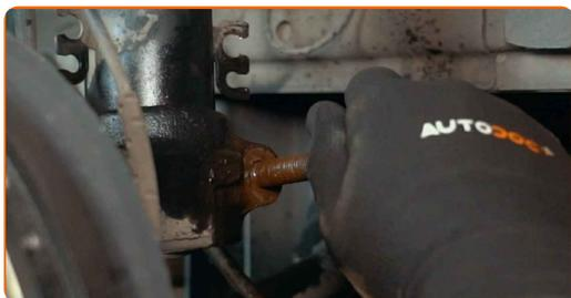
**18** Sostenga el muñón de dirección. Utilice un gato de transmisión hidráulica.
