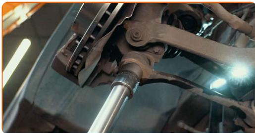
**55** Atornille la sujeción que conecta el brazo de control al subchasis. Usa una llave mixta del n.º 16. Use un vaso de impacto del n.º 18. Utilice una llave de trinquete.
