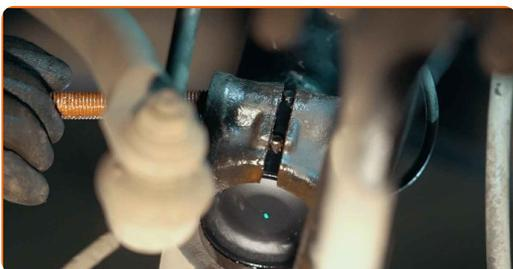
**52** Atornille la sujeción que conecta el puntal de suspensión con la mangueta de dirección. Use una llave mixta del n.º 16. Use un vaso de impacto del n.º 18. Utilice una llave de trinquete.
