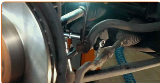
**57** Apriete la fijación inferior de la pata amortiguadora. Use un vaso de impacto del n.º 16. Use un vaso de impacto del n.º 18. Utilice una llave dinamométrica. Apriételo a un par de 100 Nm.
