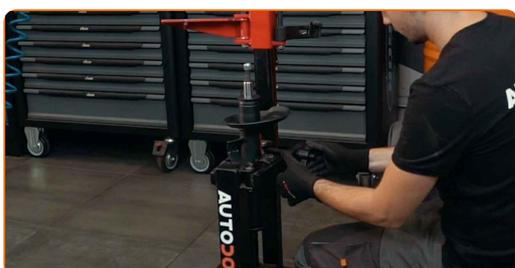
**37** Instale el guardapolvo y el tope en el amortiguador nuevo.
