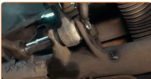
**56** Apriete las sujeciones que conectan el brazo de control y el subchasis. Usa una llave mixta del n.º 16. Use un vaso de impacto del n.º 18. Utilice una llave dinamométrica. Apriételo a un par de 110 Nm.
