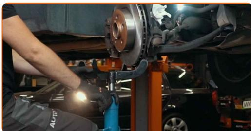
**19** Suelte la sujeción inferior que conecta el puntal amortiguador a la mangueta de dirección. Utilice un vaso de impacto especial para extraer el amortiguador. Utilice una llave de trinquete.
