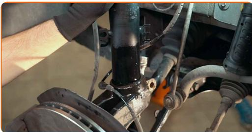
**51** Instale el perno de sujeción.
