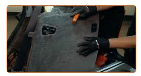
Atornille las sujeciones del revestimiento de la parte lateral del maletero. Utilice un destornillador Phillips.
