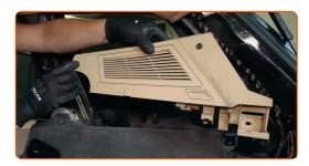
Retire los clips de sujeción del revestimiento de la parte lateral del maletero. Utilice una herramienta de recorte de plástico.
