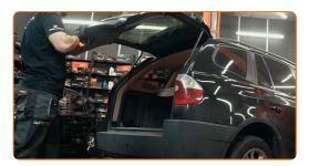
Mueva el estante plegable y libérelo de las sujeciones. Al efectuar esto, obtendrá acceso a los paneles de plástico del revestimiento lateral.
