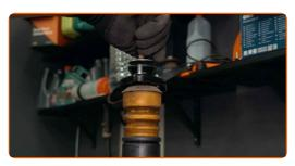
Apriete la tuerca de la varilla del amortiguador. Usa una llave mixta del n.º 17. Utilice un vaso para amortiguador NºDD6. Use una llave ajustable. Utilice una llave dinamométrica. Apriételo a un par de 14 Nm.
