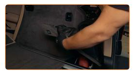
Desenrosque las sujeciones de la cubierta protectora de plástico de la carrocería. Utilice un destornillador Phillips.
