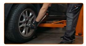
Apriete la fijación superior del amortiguador. Use un vaso de impacto del n.º 13. Utilice una llave dinamométrica. Apriételo a un par de 24 Nm.
