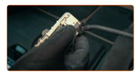
Retire el revestimiento (forro) del cinturón de seguridad.
