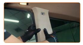
Desenrosque las sujeciones del panel del cinturón de seguridad. Utilice un destornillador Phillips.
