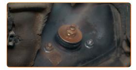
Instale la tapa de protección del soporte del amortiguador.
