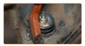
Afloje la sujeción superior del amortiguador. Use un vaso de impacto del n.º 13. Utilice una llave de trinquete.
