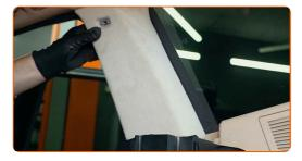
Atornille la sujeción del embellecedor del pilar de la carrocería. Utilice Torx T20. Utilice una llave de trinquete.
