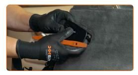
Desenrosque la sujeción del revestimiento de la parte lateral del maletero. Utilice un destornillador Phillips.
