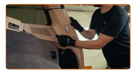
Atornille las sujeciones de la cubierta protectora de plástico de la carrocería. Utilice un destornillador Phillips.
