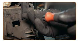
Retire el panel del cinturón de seguridad.
