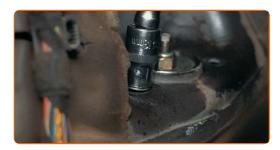
Destornille la fijación inferior del amortizador. Use un vaso de impacto del n.º 18. Utilice una llave giramachos.
