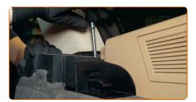
Retire los clips de la bandeja trasera. Utilice Torx T25. Utilice una llave de trinquete.
