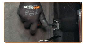
23 Separe el revestimiento de la parte lateral del maletero.
