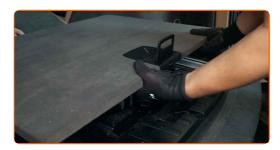
5 Separe el revestimiento de la parte lateral del maletero.
