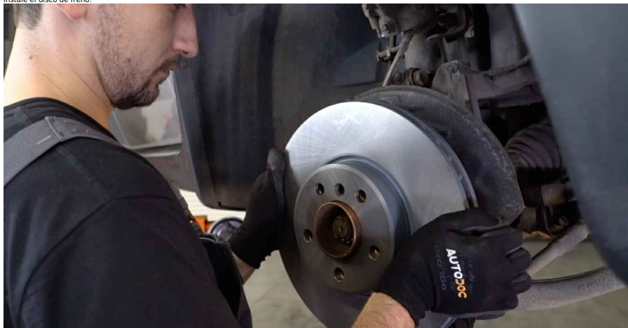
24 Apriete la fijación del disco de freno. Utilice Torx T30. Utilice una llave dinamométrica. Apriételo a un par de 16 Nm.
