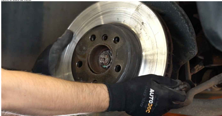
22 Limpie el cubo. Use un cepillo de alambre. Trate la superficie de contacto. Use grasa de cobre.
