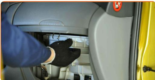
**4** Saque de la carcasa del filtro el elemento filtrante de recambio.
