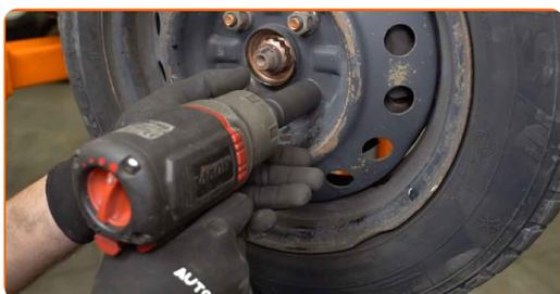
**24** Baje el automóvil y, manteniendo el orden cruzado, apriete los pernos de fijación de las ruedas. Utilice una llave de impacto para llanta # 21. Utilice una llave dinamométrica. Apriételo a un par de 103 Nm.
