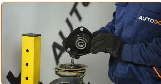
**25** Apriete la tuerca de la varilla de la pata amortiguadora. Use un vaso de impacto del n.º 17. Utilice una llave dinamométrica. Apriételo a un par de 33 Nm.
