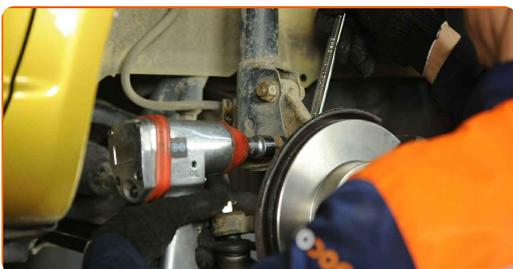
**40** Trate las sujeciones del amortiguador. Use grasa de cobre.
