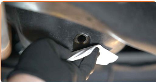
**10** Atornille en el nuevo tapón de drenaje y apriételo. Usa una llave mixta del n.º 14. Utilice una llave dinamométrica. Apriételo a un par de 25 Nm.
