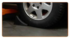
Afloje los pernos de fijación de la rueda. Utilice una llave de impacto para llanta # 19.
