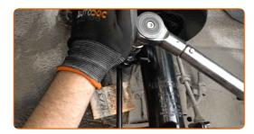
Apriete la sujeción que conecta la bieleta a la barra estabilizadora. Use un vaso de impacto del n.º 18. Utilice una llave dinamométrica. Apriételo a un par de 60 Nm.
