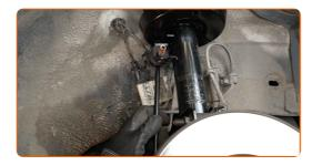
Apriete las fijaciones de la bieleta de la barra estabilizadora. Usa una llave mixta del n.º 18.
