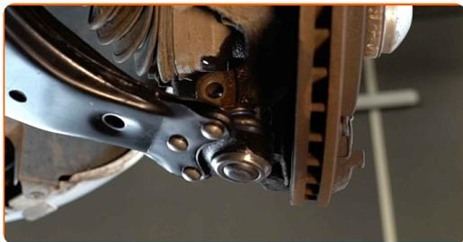
**20** Instale el perno de sujeción.
