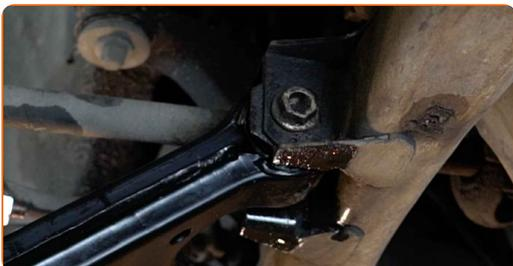
**19** Conecte la palanca inferior al muñón de dirección.
