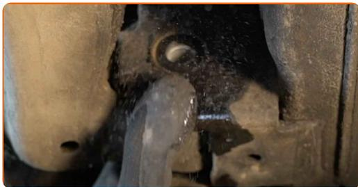
**12** Suelte la sujeción que conecta la rótula del brazo de control con la mangueta de dirección. Utilice un cincel de metal plano. Utilice un martillo.
