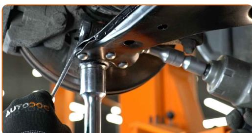
**23** Atornille la fijación delantera de la palanca. Usa una llave mixta del n.º 18. Use un vaso de impacto del n.º 18. Utilice una llave giramachos.
