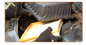
Limpie la cubierta y la carcasa del filtro de aire.
