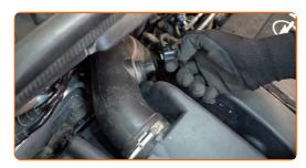
Levante ligeramente la cubierta de la carcasa del filtro de aire.
