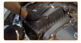
Atornille los tornillos de sujeción de la cubierta del filtro de aire. Utilice Torx T25.
