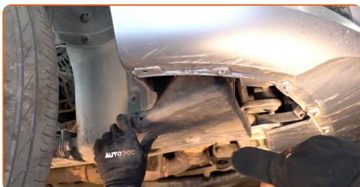
**15** Instale y apriete las sujeciones de la cubierta del paso de rueda. Utilice Torx T25.
