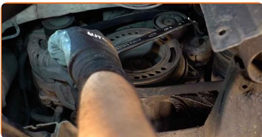
**12** Coloque la correa acanalada en V en la polea tensora.
