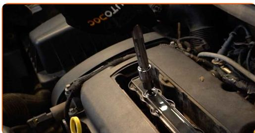
**6** Levante la bobina de ignición haciendo palanca. Use una palanca. Saque la bobina de ignición del pozo de la bujía.
