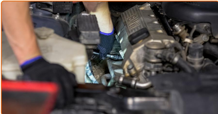
Instale las nuevas bujías en sus asientos de montaje. Use el vaso de bujía # 16.
