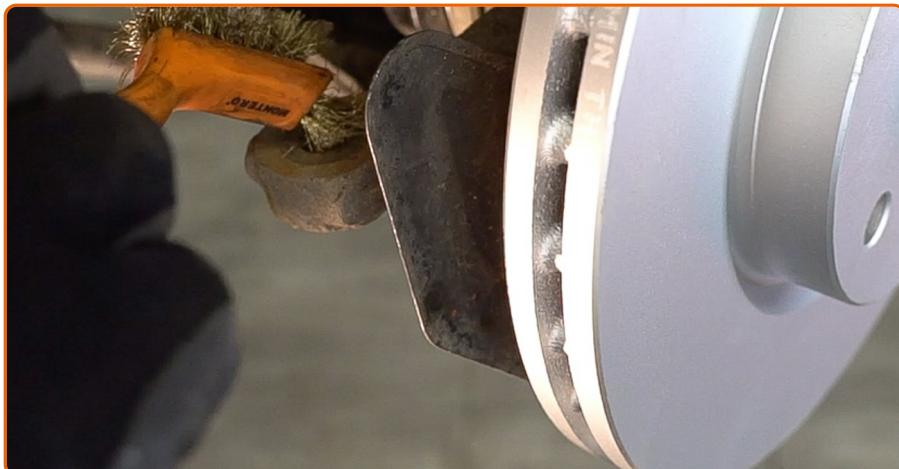
Limpie el asiento de montaje del extremo de la barra de acoplamiento. Use un cepillo de alambre. Use el aerosol WD-40.
