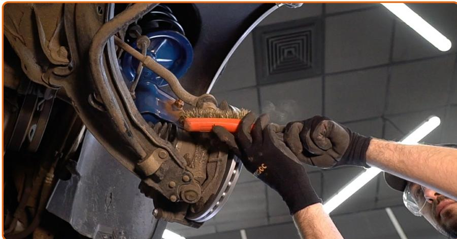
Limpie las sujetaciones que conectan el extremo de la barra de acoplamiento con la mangueta de dirección. Use un cepillo de alambre. Use el aerosol WD-40.
