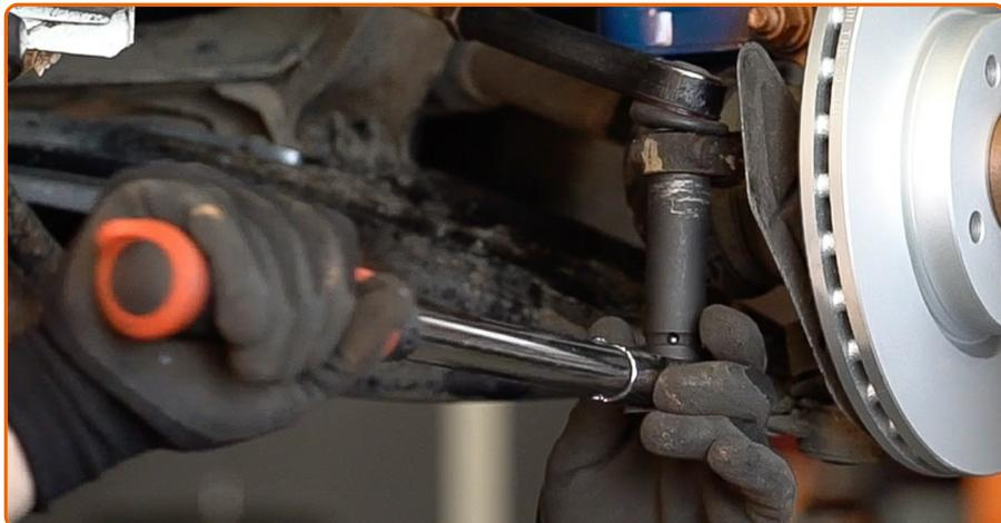
Apriete la tuerca de fijación que conecta el extremo de la barra de acoplamiento a la mangueta de dirección. Use un vaso de impacto del n.º 17. Utilice una llave dinamométrica. Apriételo a un par de 47 Nm.
