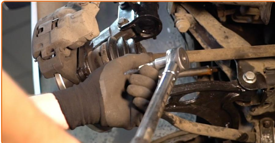
Apriete la fijación de la pinza del cálibre de freno. Use un vaso de impacto del n.º 17. Utilice una llave dinamométrica. Apriételo a un par de 70 Nm.
