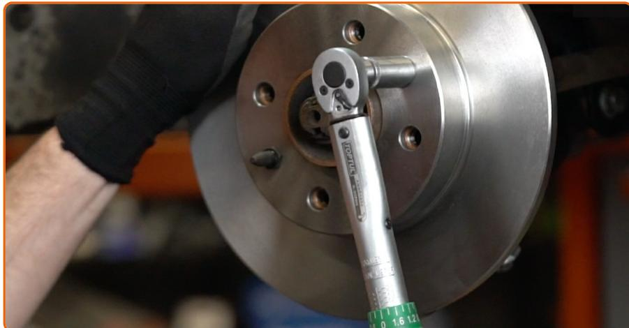
Apriete la fijación del disco de freno. Use un vaso de impacto del n.º 12. Utilice una llave dinamométrica. Apriételo a un par de 9 Nm.
