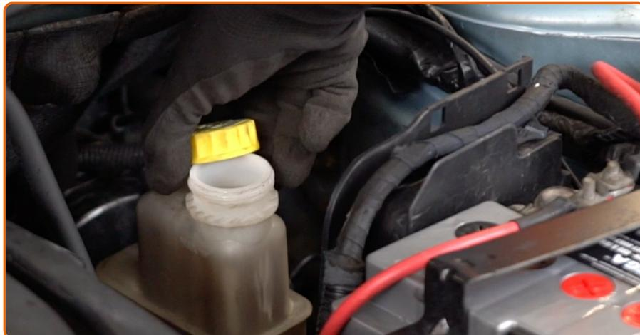
Apriete el tapón del depósito de líquido del freno.
