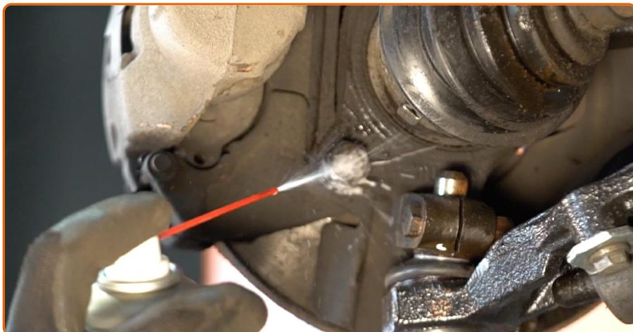
Limpie las sujeciones del soporte de la pinza del freno. Use un cepillo de alambre. Use el aerosol WD-40.
