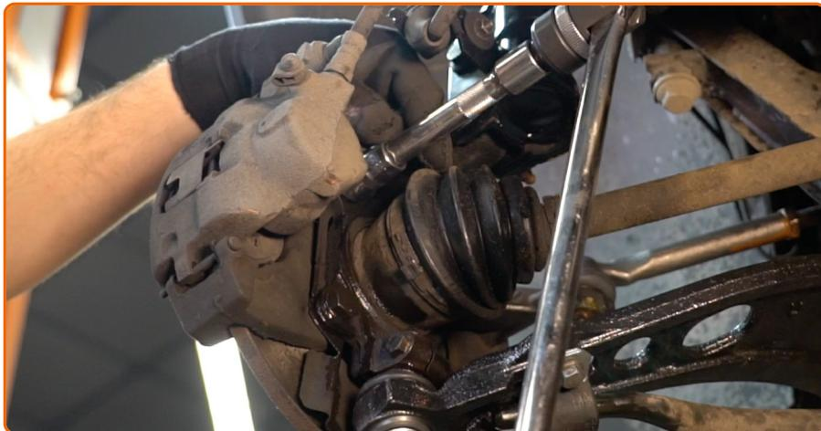
Destornille la fijación de la pinza del cálibre de freno. Use un vaso de impacto del n.º 17. Utilice una llave de trinquete. Utilice una llave giramachos.
