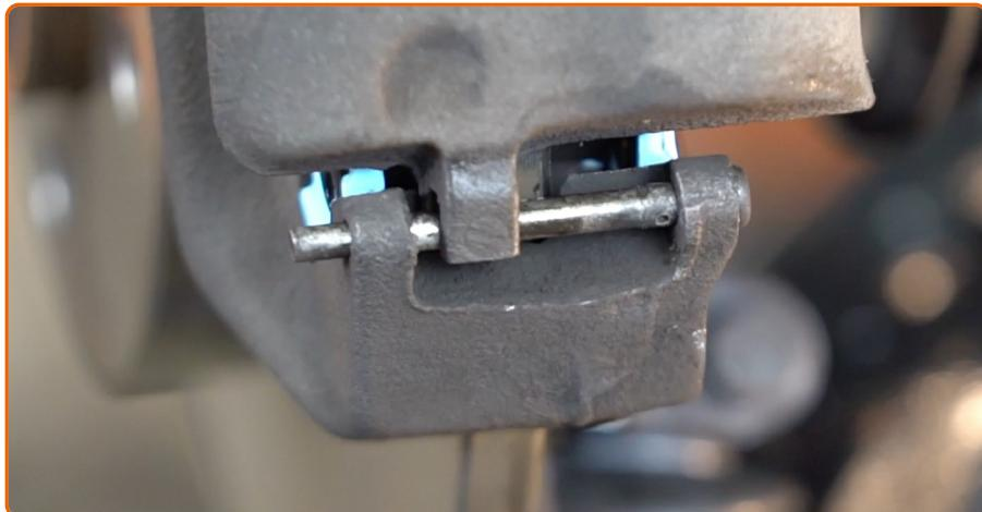
Instale la sujeción de la pinza de freno.
