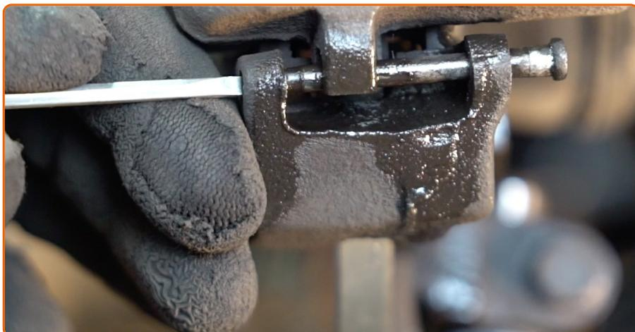
Retire la sujeción de la pinza de freno. Utilice un destornillador plano.
