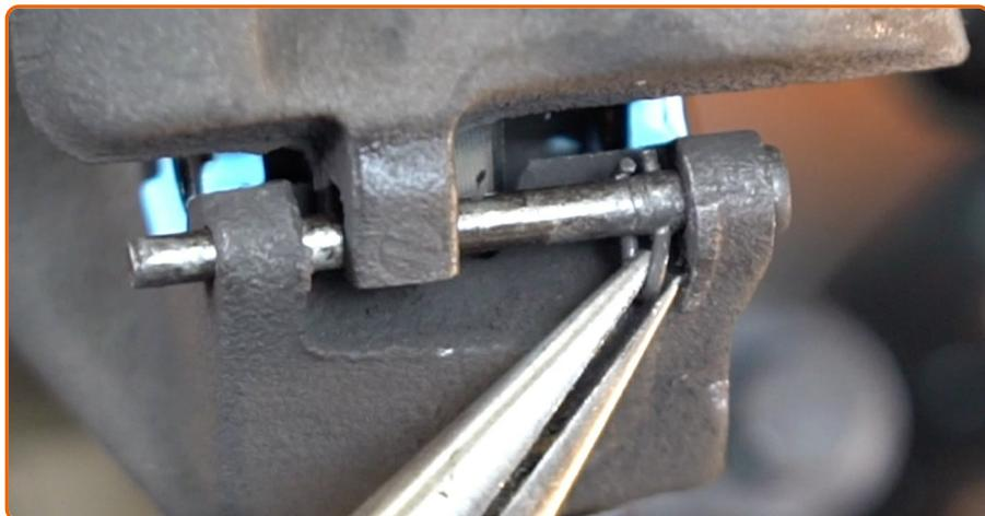
Instale el tornillo clavija de la pinza de freno.
