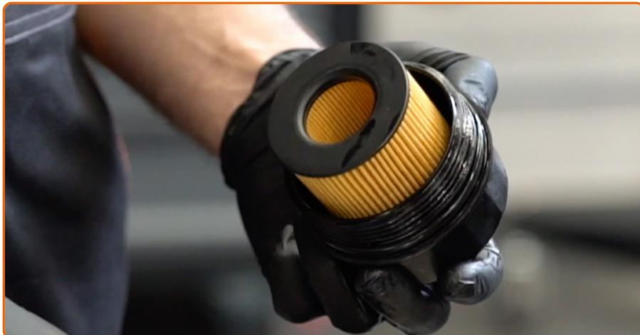
Instale una nueva junta tórica en el asiento de montaje de la cubierta del filtro.
