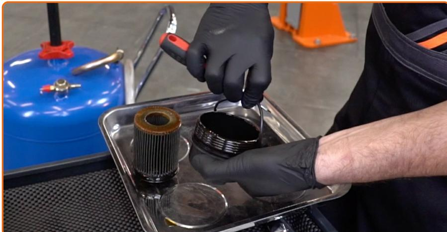
Retire la junta tórica de la tapa del filtro de aceite. Utilice un destornillador plano.
