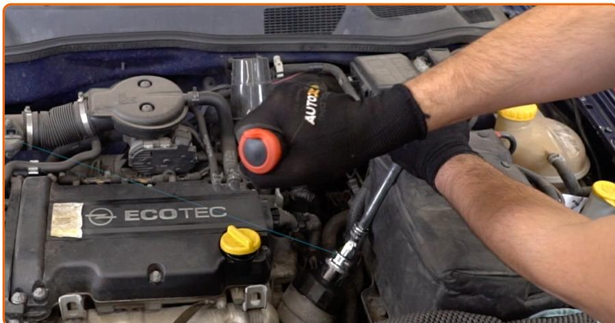
Atornille la tapa. Use un vaso de impacto del n.º 32. Utilice una llave dinamométrica. Apriételo a un par de 25 Nm.
