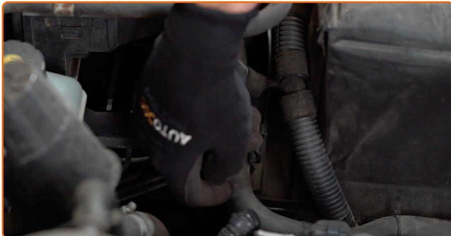
Tire hacia abajo la tubería de refrigerante.
