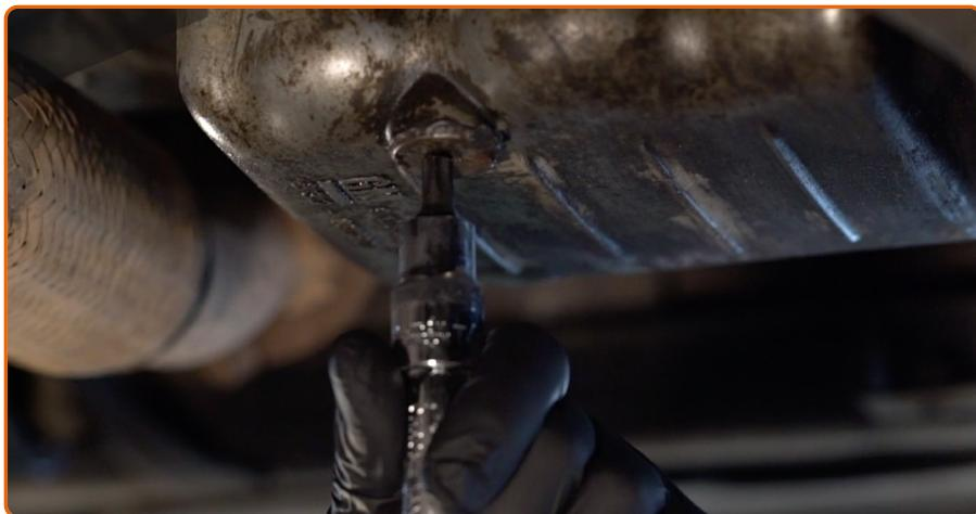
Destornille el tapón de desagüe. Utilice Torx T45. Utilice una llave de trinquete.
