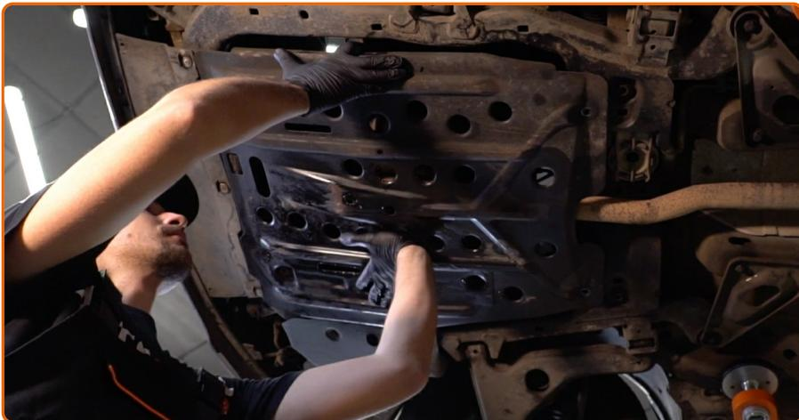
Vuelva a instalar la cubierta inferior del cárter de aceite.
