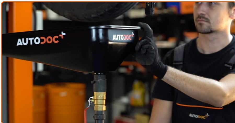
Coloque un contenedor para el aceite de desecho con al menos 3.5 l de capacidad debajo del orificio de drenaje.
