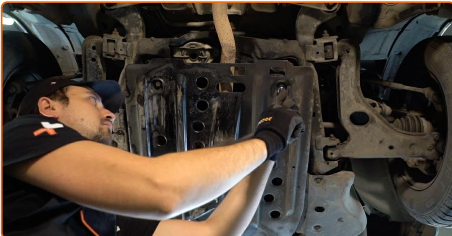
Afloje y deshaga las sujeciones de la cubierta inferior del cárter de aceite.
