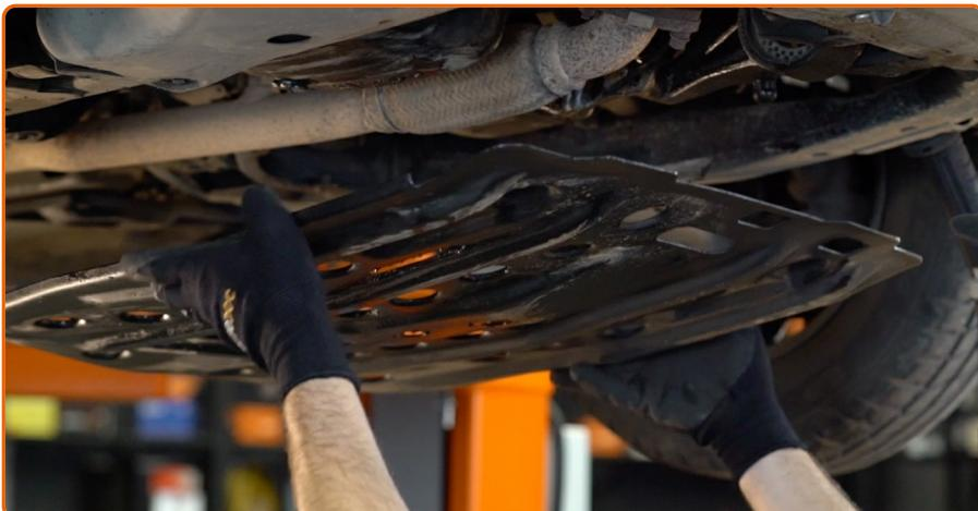
Retire la cubierta del cárter de aceite. Use un vaso de impacto del n.º 12. Utilice una llave de trinquete.
