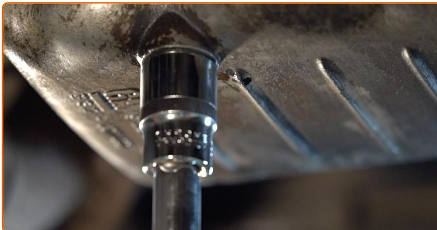
Atornille en el nuevo tapón de drenaje y apriételo. Utilice Torx T45. Utilice una llave dinamométrica. Apriételo a un par de 35 Nm.
