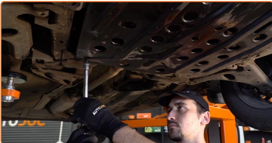
Apriete los sujetadores de la cubierta inferior del cárter de aceite. Use un vaso de impacto del n.º 12. Utilice una llave de trinquete.
