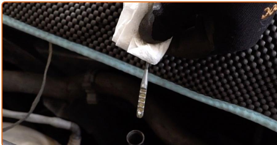
Verifique el nivel de aceite en 5 minutos después de parar el funcionamiento del motor, usando la tinta, y en caso necesario añada un poco más de aceite.
