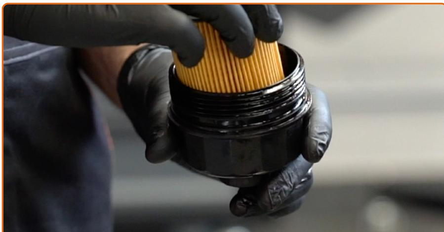
Instale el nuevo filtro de aceite en el asiento de montaje de la cubierta del filtro.
