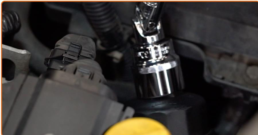
Destornille la tapa del cuerpo del filtro junto con el elemento filtrante antiguo. Use un vaso de impacto del n.º 32. Utilice una llave de trinquete.
