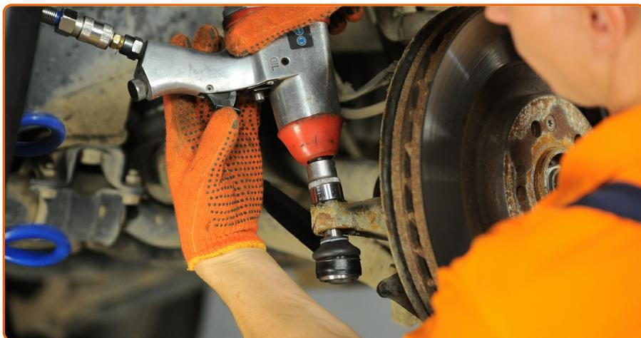
Apriete la tuerca de fijación que conecta el extremo de la barra de acoplamiento a la manigueta de dirección. Use un vaso de impacto del n.º 22. Utilice una llave dinamométrica. Apriételo a un par de 75 Nm.
