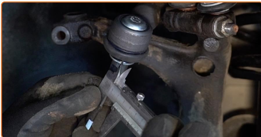
Mida y anote la longitud de la parte libre de la rosca de la barra de dirección o anote la cantidad de las revoluciones completas del detalle durante el desmontaje para que durante el montaje en la medida de lo posible no cambiar el ángulo de convergencia de las ruedas. Utilice un calibrador Vernier.
