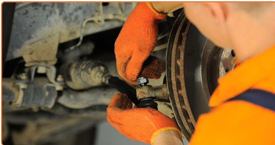
Conecte la punta de la barra de dirección al muñón de dirección.
