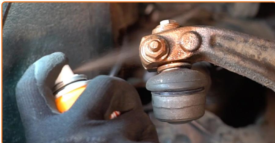
Trate la sujeción que conecta el extremo de la barra de acoplamiento a la mangueta de dirección. Use grasa de cobre.
