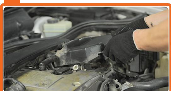
Instale la tapa delantera del motor.
