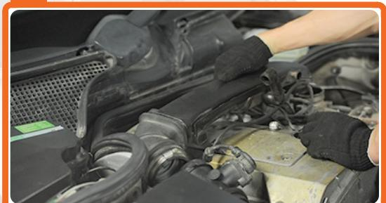
Instale la tubuladura del filtro de aire.
