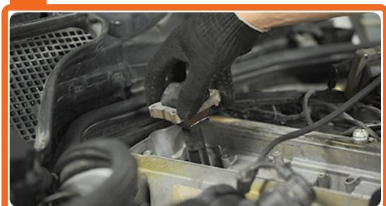
Coloque las bobinas de encendido encima de las bujías y fíjelas.
