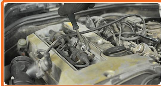
Destornille los pernos de fijación de las bobinas de encendido.
