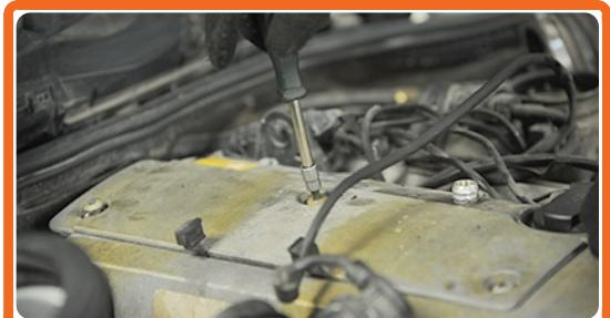
Instale la cubierta de la culata de cilindros.
