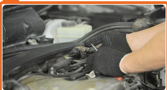
Retire la tubuladura del filtro de aire.
