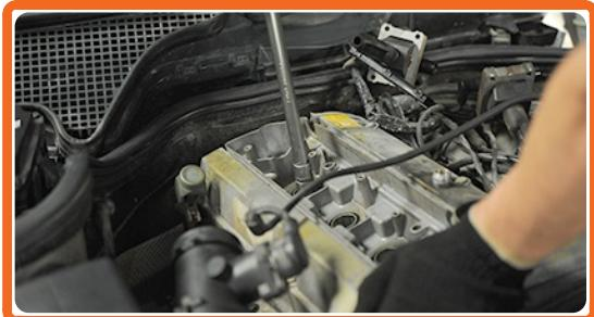
Retire las velas con la ayuda de la llave para bujías y sitúelas sobre la superficie de trabajo en el orden de su instalación en el motor.
