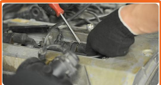
Desconecte las clavijas de las bobinas de encendido.
