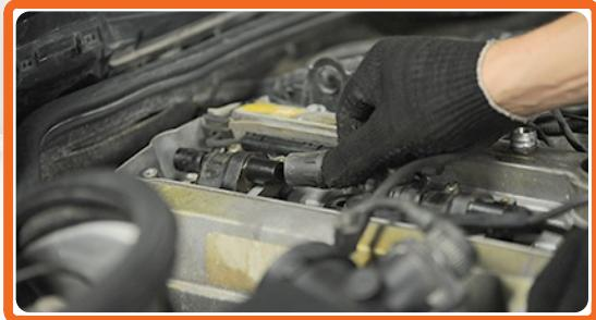
Conecte las clavijas a las bobinas de encendido.
