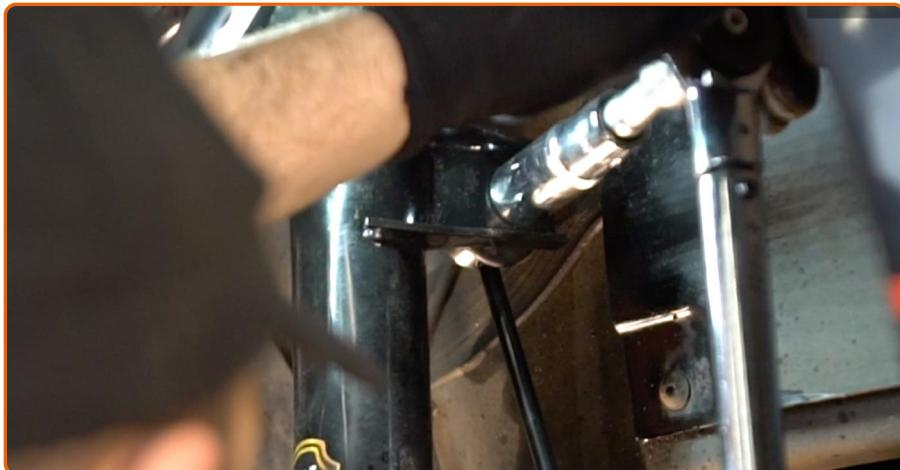
Apriete la sujeción que conecta la bieleta de barra estabilizadora al amortiguador. Usa una llave mixta del n.º 17. Use un vaso de impacto del n.º 18. Utilice una llave dinamométrica. Apriételo a un par de 60 Nm.
