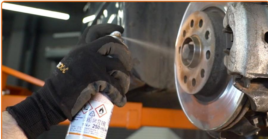
Trate la superficie donde el disco del freno entra en contacto con la llanta de la rueda. Use grasa de cobre.
