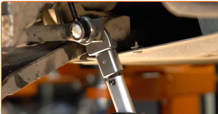
Apriete la sujeción que conecta la bieleta a la barra estabilizadora. Usa una llave mixta del n.º 17. Use un vaso de impacto del n.º 18. Utilice una llave dinamométrica. Apriételo a un par de 60 Nm.
