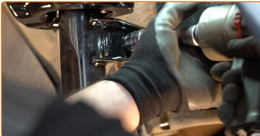
Desatornille la sujeción que conecta la bieleta de barra estabilizadora al amortiguador. Use un vaso de impacto del n.º 18. Utilice una llave de trinquete.
