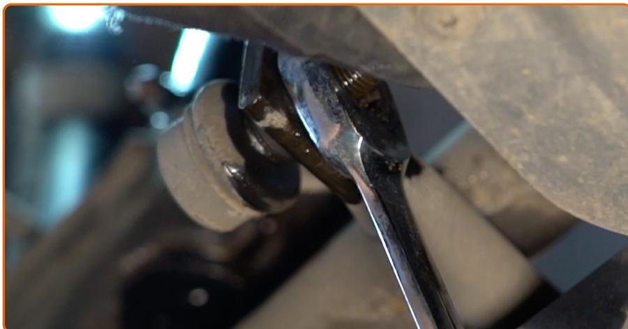
Desatornille la sujeción que conecta la bieleta a la barra estabilizadora. Usa una llave mixta del n.º 18. Use Vaso HEX No. H5. Utilice una llave de trinquete.
