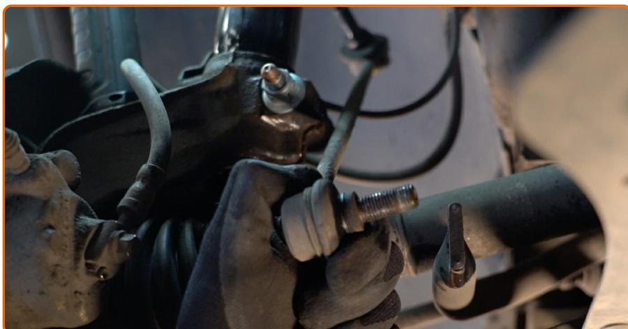
Retire el enlace estabilizador de estabilidad transversal.
