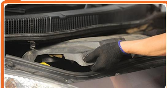
Instale la tapa de plástico del motor.
