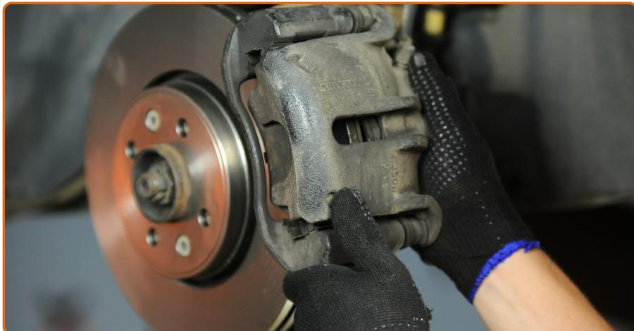
Instale el cárter de freno y fíjelo.
