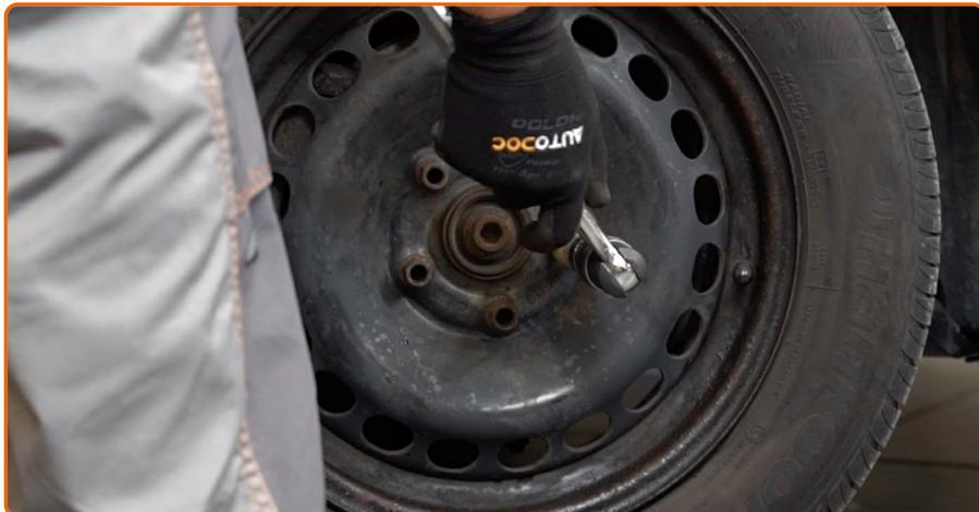
Baje el automóvil y, manteniendo el orden cruzado, apriete los pernos de fijación de las ruedas. Utilice una llave de impacto para llanta # 19. Utilice una llave dinamométrica. Apriételo a un par de 120 Nm.
