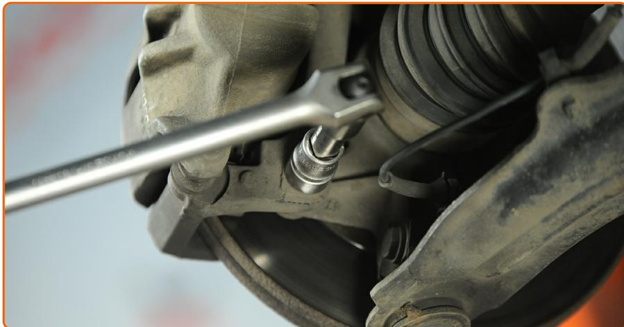
Apriete las sujetaciones de la pinza del freno. Use un vaso de impacto del n.º 13. Utilice una llave dinamométrica. Apriételo a un par de 35 Nm.
