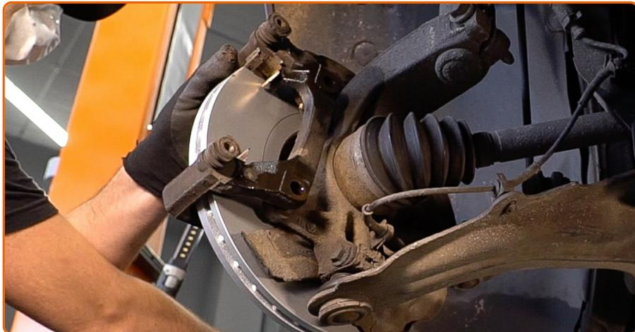
Instale la pinza del cáliber de freno.
