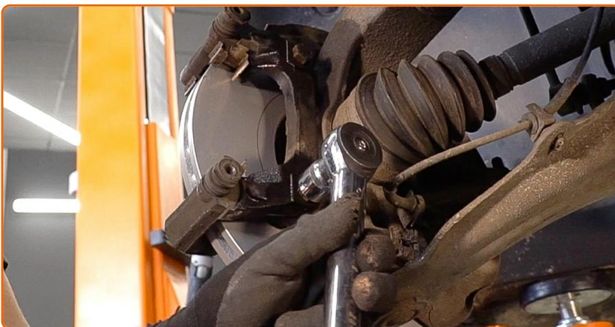
Apriete la fijación de la pinza del cálibre de freno. Use un vaso de impacto del n.º 18. Utilice una llave dinamométrica. Apriételo a un par de 78 Nm.
