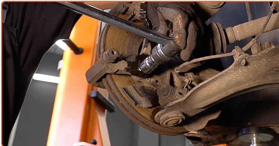
Destornille la fijación de la pinza del cáliber de freno. Use un vaso de impacto del n.º 18. Utilice una llave de trinquete.
