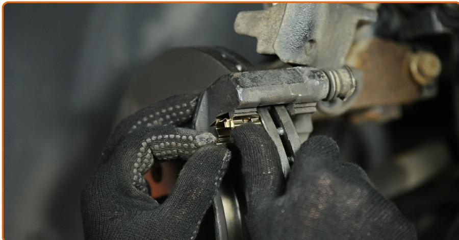
Instale los muelles de retención de las pastillas de freno.
