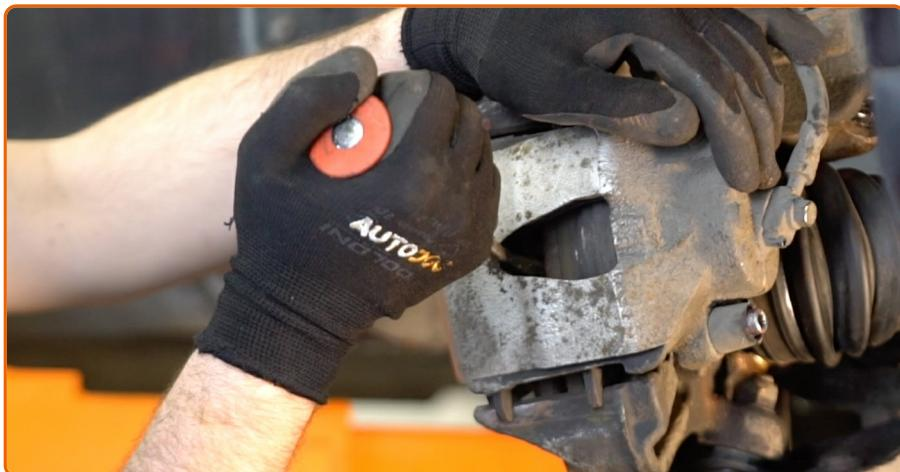
Separé las pastillas de freno. Use una palanca.
