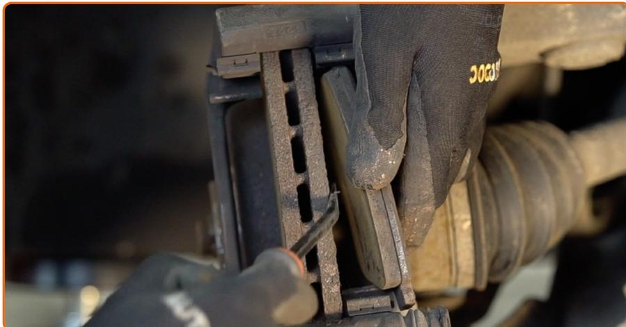
Retire las pastillas de freno. Use una palanca.
