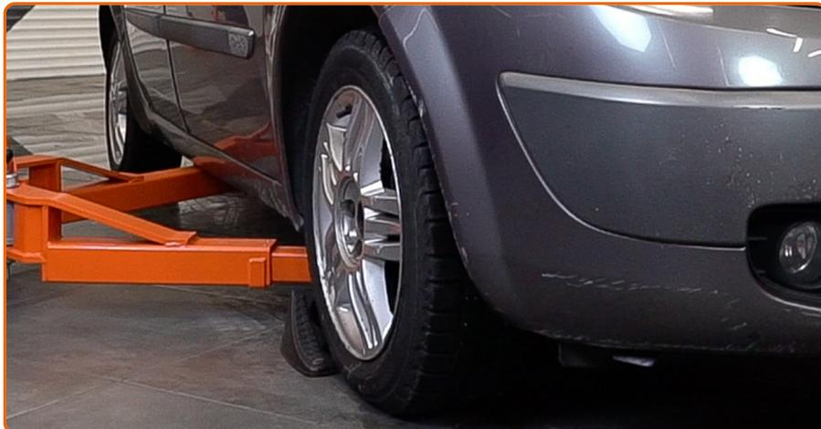
Afloje los pernos de fijación de la rueda. Utilice una llave de impacto para llanta # 19.
