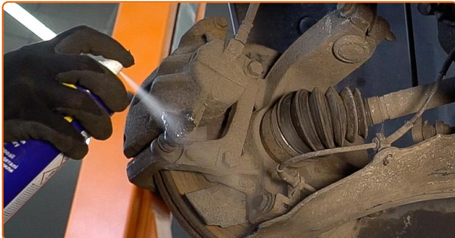
Limpie las sujeciones de la pinza del freno. Use un cepillo de alambre. Use el aerosol WD-40.
