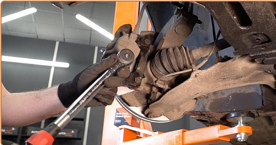
Establezcan el soporte de freno y lo fijen. Use un vaso de impacto del n.º 13. Utilice una llave dinamométrica. Apriételo a un par de 35 Nm.
