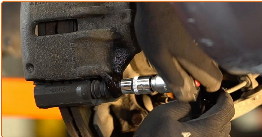
Destornille la fijación del cálibre de freno. Use un vaso de impacto del n.º 13. Utilice una llave de trinquete.
