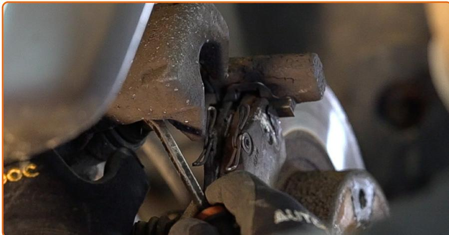
Retire el soporte de freno. Use una palanca.
