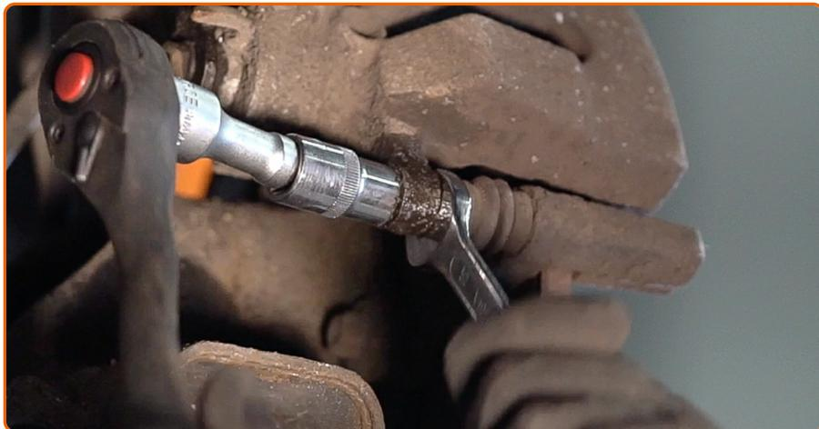
Destornille la fijación del cálibre de freno. Usa una llave mixta del n.º 15. Use un vaso de impacto del n.º 13. Utilice una llave de trinquete.
