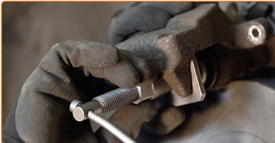
Empuje hundiendo el cálibre de freno. Utilice la herramienta de retorno del pistón de freno.
