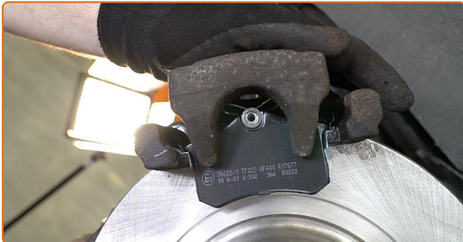
Establezcan el soporte de freno y lo fijen. Usa una llave mixta del n.º 15. Use un vaso de impacto del n.º 13. Utilice una llave dinamométrica. Apriételo a un par de 78 Nm.
